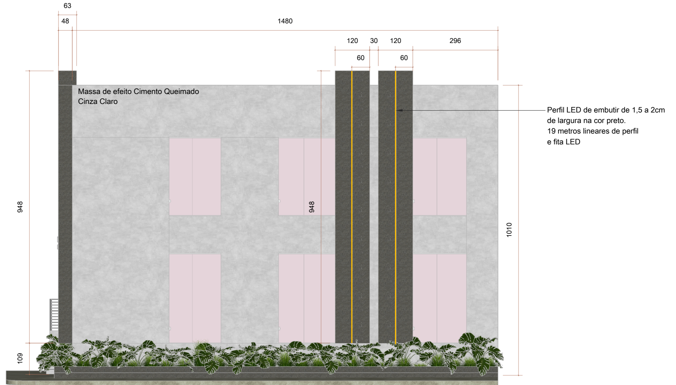
01 Fachada Lateral Direita ESCALA: 1/75
